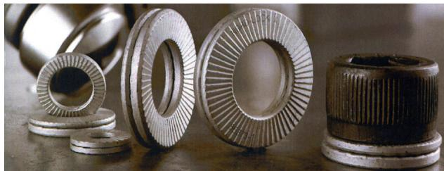
Una coppia di rondelle Nord-Lock® X-SERIES è costituita da una serie di camme su un lato e una dentatura radiale sul lato opposto. Il bloccaggio del giunto bullonato viene ottenuto grazie alla tensione anziché all'attrito. La forma conica crea una riserva elastica nel giunto bullonato, compensando la perdita di precarico ed evitando l'allentamento. Concetti innovativi nel campo del fissaggio dei bulloni, ampliano le possibilità progettuali ottenendo risultati eccellenti.
