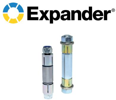
Il sistema Expander è la soluzione permanente all'usura dei perni, frequente causa di guasti delle apparecchiature. A scopo preventivo evita riparazioni o integrazioni sulle macchine. Questo tipo di tecnologia elimina la necessità di effettuare saldature e alesature in linea permettendo tolleranze maggiori.
